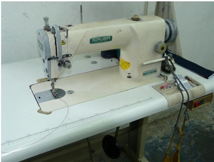
**Figura Nº 61. Máquina Plana pesada**
